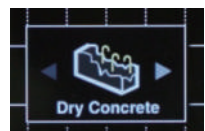
Λειτουργία ανίχνευσης σε στεγνό μπετόν
