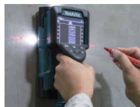
Οδηγός laser για να υποδείξει το κατακόρυφο κέντρο του αισθητήρα και τον άξονα της κατεύθυνσης σάρωσης. Βοηθά στη σωστή σάρωση κατά μήκος του οριζόντιου άξονα
