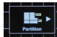
Λειτουργία ανίχνευσης σε ξύλο ή γυψοσανίδα
